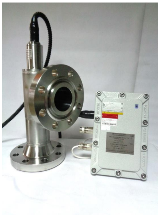
Рисунок 2 – Внешний вид влагомера FIZEPR-SW100 с угловыми датчиками
