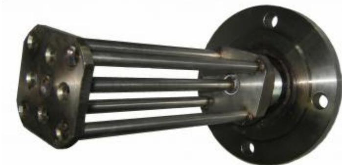
Конструкция влагомера FIZEPR-SW100.21 обеспечивает измерения в потоке - в трубопроводах диаметром от 150мм (Dy150) и выше. Зонд датчика закреплен на фланце Dy100. Для установки датчика к трубопроводу должен быть приварен патрубок с соответствующим типом фланца.
