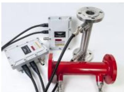
Влагомер состоит из электронного блока и датчика. Датчик влагомера варианта FIZEPR-SW100.20.x выполнен в виде секции трубы с фланцами, материал – сталь 12X18H10T. Внутри трубы установлен зонд - пруток П-образной формы, выполненный из нержавеющей стали той же марки.
