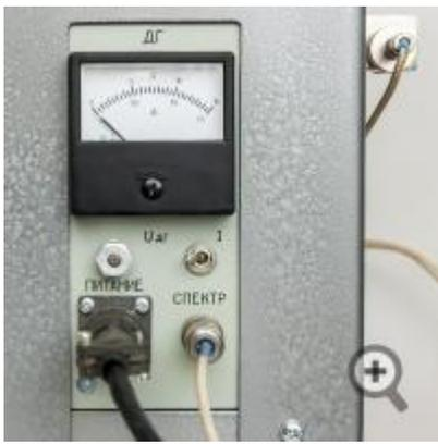
Спектрометр ЭПР, индикатор измерительного модуля
