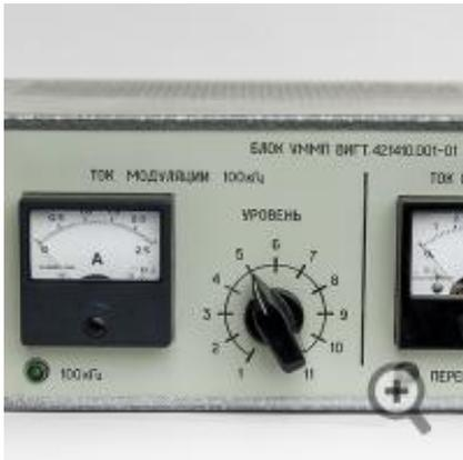
Спектрометр ЭПР. Блок управления.
