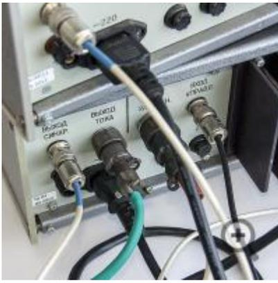
Подключения блоков спектрометра
