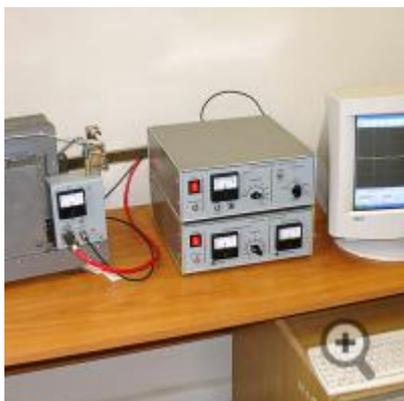
Спектрометр с подключением к ПК
